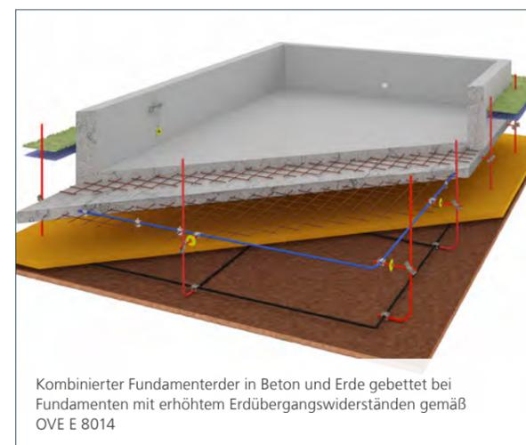
Kombinierter Fundamenterder in Beton und Erde gebettet bei Fundamenten mit erhöhtem Erdübergangswiderständen gemäß ÖVE E 8014
