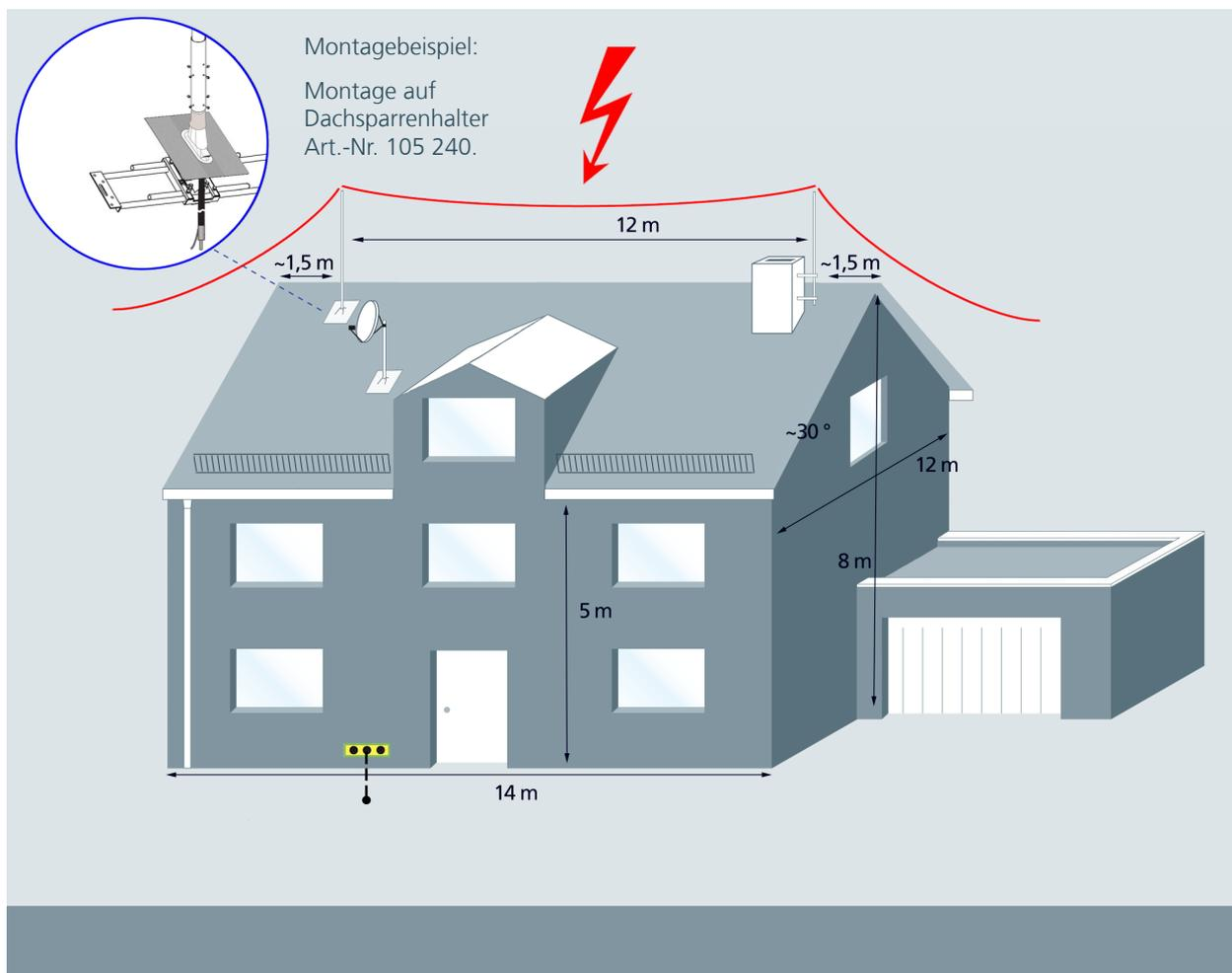
Nicht auf Potentialausgleich vergessen! Bei Errichtung einer Äußeren Blitzschutzanlage muß die Blitzschutz-Potentialausgleichschiene (zB. Art.-Nr. 563 200) gemäß ÖVE/ÖNORM EN 50164-1 für Blitzströme (10/350)  $\mu$ s geprüft sein.
