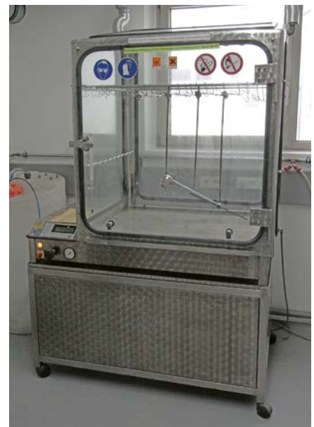
Bild 2: Prüfungen mit dem Kesternichgerät.
