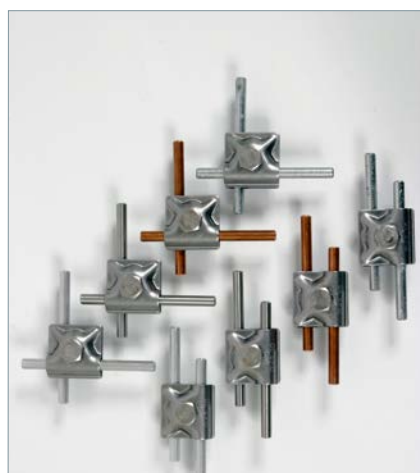
Bild 4: Prüfkombinationen für MV-Klemme (Parallel- und Kreuzanordnung).
