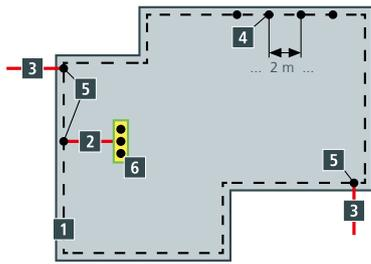
**Anschlusssteil 2** zur **Haupterdungsschiene 6** und
