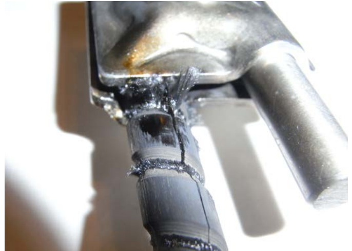
Prüflinge nach Belastung mit 20 kA (10/350 µs Blitzstrombelastung)
