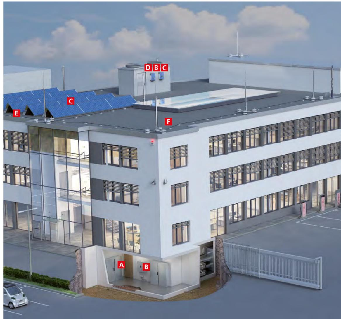
Die PV-Module müssen im Schutzbereich der getrennten Fangeinrichtung angeordnet sein – unter Einhaltung des Trennungsabstandes „s“.
