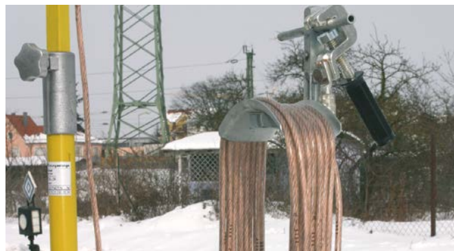
Erdungsspieß mit aufgewickelter Erdungsleitung.
