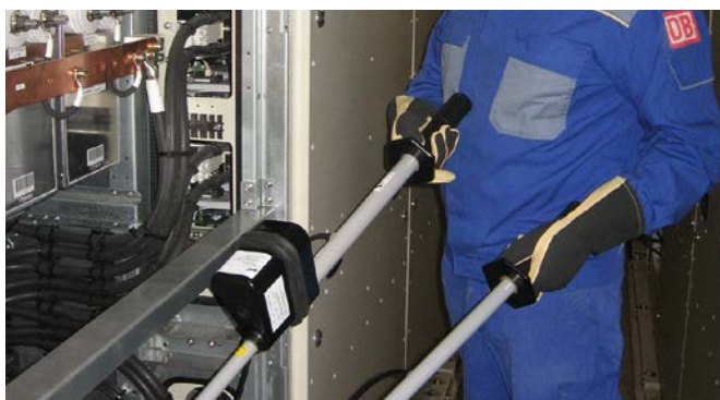
Gleichspannungsprüfer PHE/G II für Gleichstromzwischenkreise (ICE-Triebkopf).
