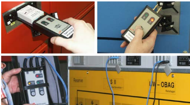
Set zum Festellen der Spannungsfreiheit, Prüfen der Schnittstelle und auf Phasengleichheit in HR- und LRM-Systemen im Kunststoffkoffer.
