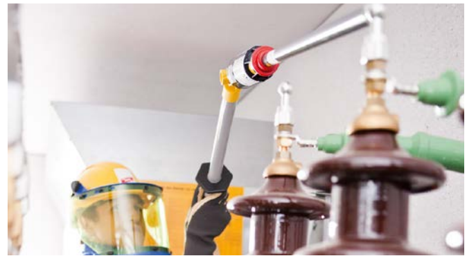
Prüfkopf PHE III mit Universalzahnkupplung und Isolierstange.
