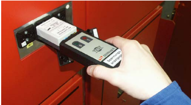
Der HR-LRM Messadapter ermöglicht die Verwendung eines LRM-Anzeigegerätes an einer HR-Messbuchse.
