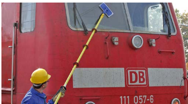
Scheibenreinigung einer E-Lokomotive mit dem Isolierstangen-Set.
