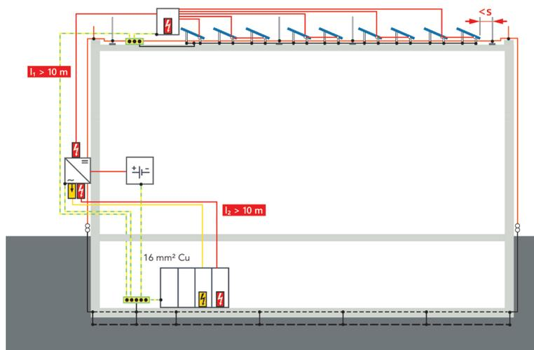
Kann der nach ÖVE/ÖNORM EN 62305-3 errechnete Trennungsabstand ( $s$ ) nicht eingehalten werden, muss ein Blitzschutz-Potentialausgleich durchgeführt werden.<sup>1)</sup>
