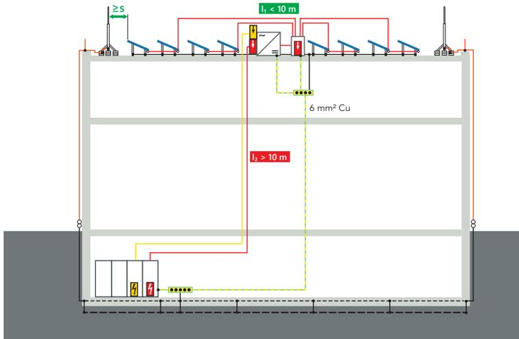
Die PV-Module müssen, unter Einhaltung des Trennungsabstandes (s), im Schutzbereich der getrennten Fangeinrichtung angeordnet sein. Dabei sollte ein Blitzschutzsystem, wie z. B. HVI Blitzschutz, bevorzugt werden, das unter Berücksichtigung der erforderlichen Trennungsabstände keine direkte Verbindung zur PV-Anlage aufweist.<sup>1)</sup>
